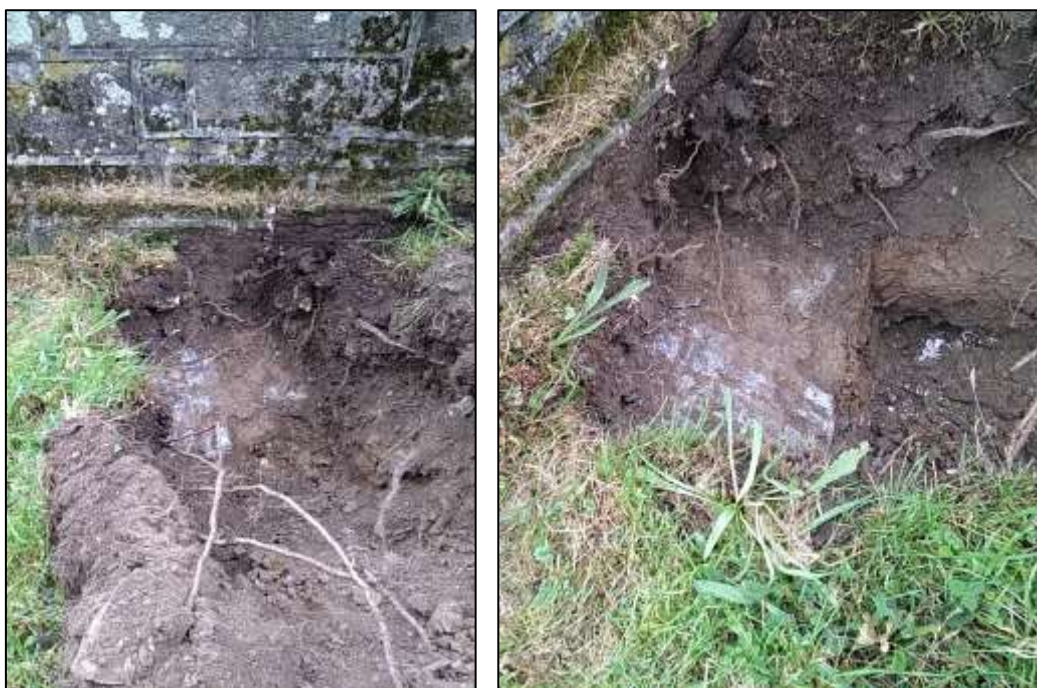
Photographies du sondage RF7 – Un bloc ou affleurement schisteux, en débord de 0.4 à 0.55 m par rapport à la façade a été mis en évidence sous le mur de la Chapelle. Il descend au moins à 0.55 m sous le niveau du terrain en rive de Chapelle. Sous la terre végétale en tête, les terrains présentent un faciès de remblai sablo-limoneux.
