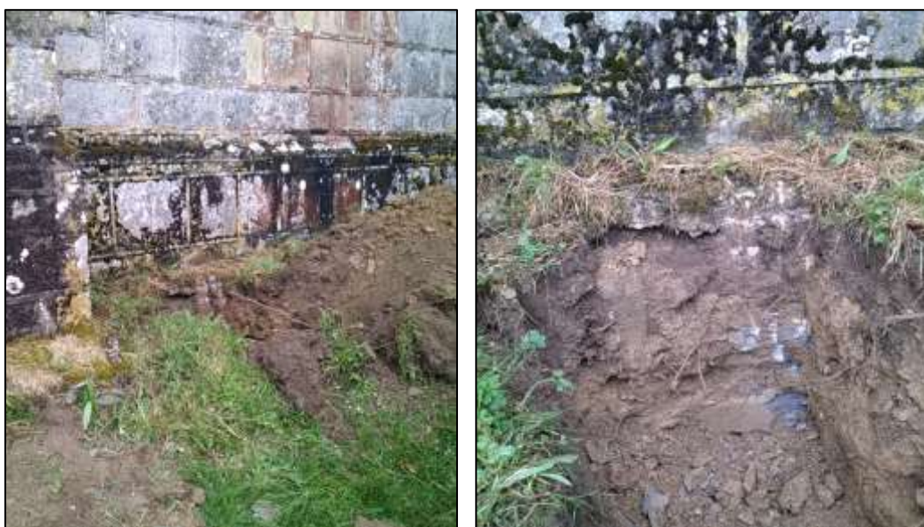
Photographies du sondage RF9 – Réalisé au niveau du même mur que RF8. Le débord du bloc ou de l'affleurement est toutefois réduit à 0.15 m par rapport à la façade a été mis en évidence sous le mur de la Chapelle. Il descend au moins à 0.7 m sous le niveau du terrain en rive de Chapelle. Sous la terre végétale en tête, les terrains présentent un faciès d'altérite schisteuse sablo-limoneuse.
