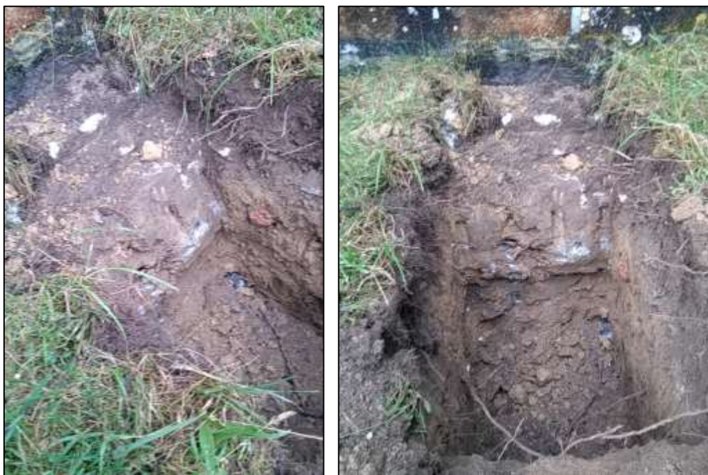
Photographies du sondage RF8 – Un bloc ou affleurement schisteux, en débord de 0.35 m environ par rapport à la façade a été mis en évidence sous le mur de la Chapelle. Il descend au moins à 0.8 m sous le niveau du terrain en rive de Chapelle. Sous la terre végétale en tête, les terrains présentent un faciès d'altérite schisteuse sablo-limoneuse.
