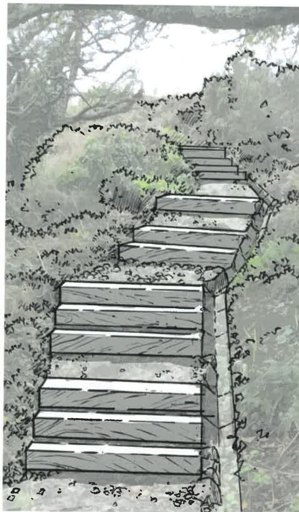
Secteur 1 Escalier en traverse paysagère en bois et fossé d'évacuation des eaux pluviales, emmarchement largeur 1,2 m (essences exotiques proscrites)
